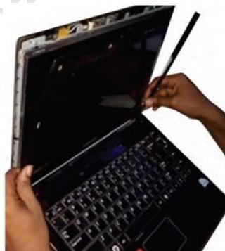
**Fig. 2.23: Remove screen bezel**
