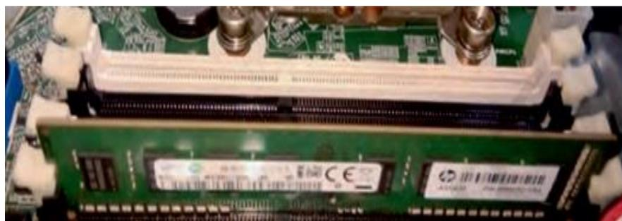
**Fig. 3.13 Lock the RAM module**
