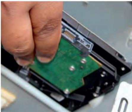
**Fig. 1.12: Insert hard disk**
